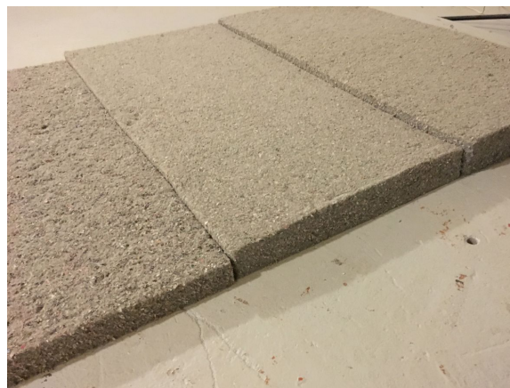
Figur 2: De tre tjocklekarna av iCell Skiva som mättes: 45, 70 och 95 mm.
