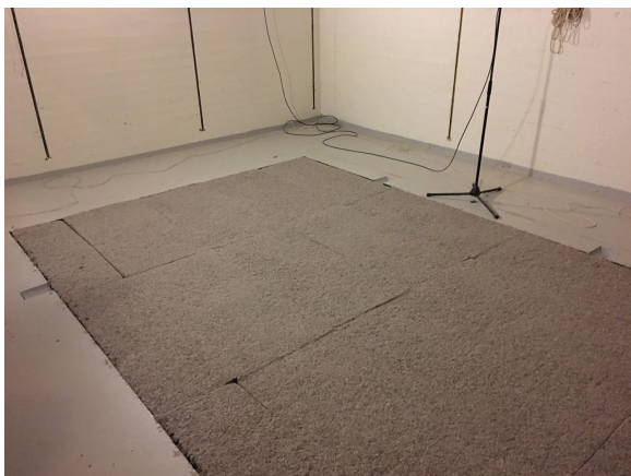
Figur 1: 10 m 2 av iCell Skiva W45 på plats i efterklangsrummet.
